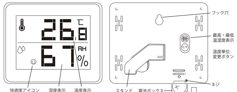
※ご使用前に電池ボックスを開けて絶縁シートを抜いてください。液晶画面に貼っているダミーシールもはがしてください。
